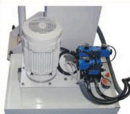
Vnější hydraulický agregát s retenční nádobou u modelů S131, S201, M14, M24
