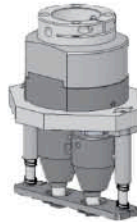
Těleso s více hlavami (2) s přidřovačem plechu
