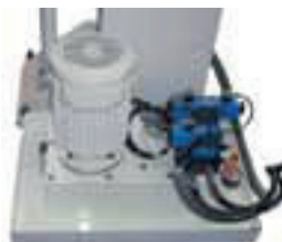
Groupe hydraulique hors machine avec bac de rétention sur mod. S131, S201, M14, M24
